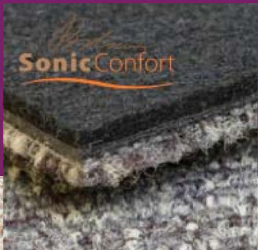
La sous-couche Sonic Confort® de Balsan est un envers feutre, contenant au minimum 70% de fibres polyester recyclées post-consommateurs à partir de bouteilles alimentaires recyclées, puis triées, lavées et refondues pour la fabrication des nouvelles fibres. Cet envers procure des avantages acoustiques inégalables pour amortir les bruits de chocs :  $DLw=36$  dB et les bruits aériens :  $aw=0,30$ .
